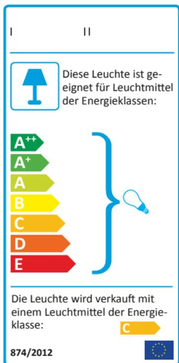
Dieses Label kennzeichnet eine Leuchte, in die Lampen aller Energieeffizienzklassen eingesetzt werden können. Die Leuchte verfügt demnach über einen Standardsockel und ist nicht auf bestimmte Lampentechnologien beschränkt.
